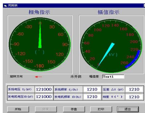
其中旋转方向标志： $\leftarrow$  表示顺时针  $\rightarrow$  表示逆时针，幅值差为系统电压与发电机电压的幅值差，（压差  $\Delta U$  为矢量差）
