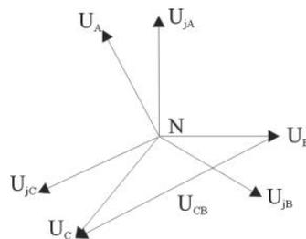
要想使仪器测量同期过程中的  $U_j$ 、 $\Delta U$ 、 $\theta_i$  (同期角度), 就必须使  $U_j$  信号的幅值、方向都与定子侧  $U_{CB}$  一致, 因此实际测量应特别注意:
