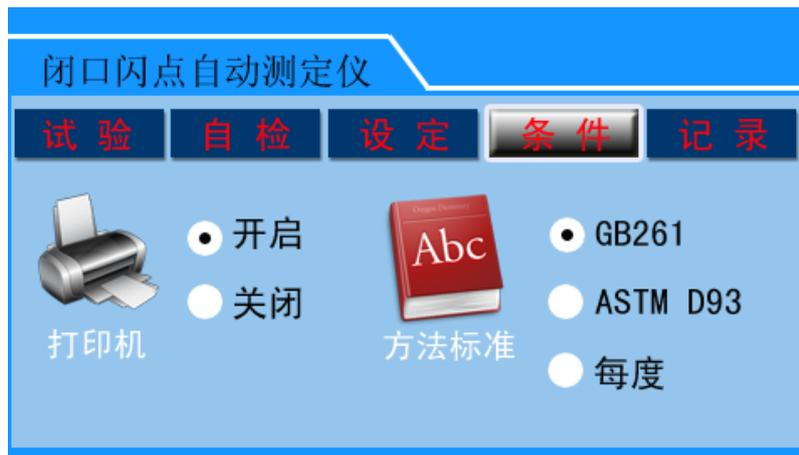
该界面用以设置打印机的开启、关闭及测试试样所符合的标准，采用的标准包括 GB261-2008 和 ASTM D93, 设定为“每度”时，测试试样开始后，在温度上升约 5℃时，每升高 1 度即开盖并点火一次，试验试样是否闪火，适用于并不确知闪点范围的试样。
