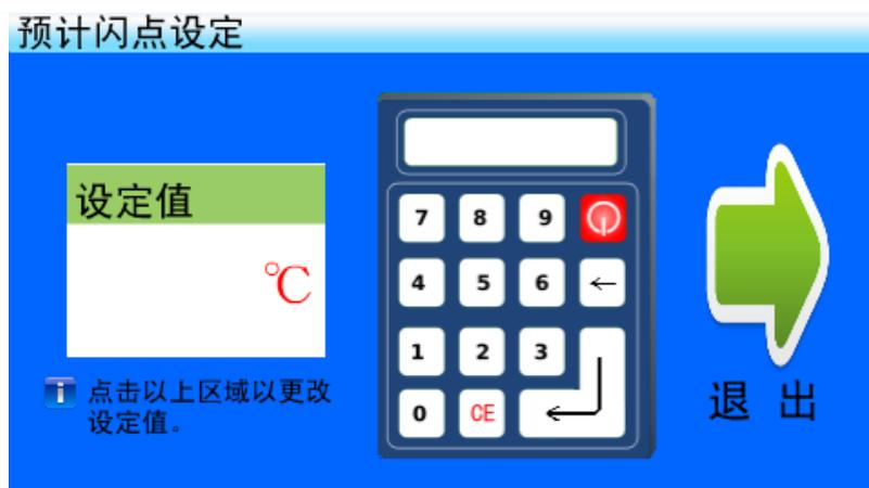
该界面下，点击“设定值”区域，键盘上方预计闪点设定值输入框处光标闪烁，可以输入数字，并按“←”确认输入。要删除输入的数字，可以点击“←”。点击右上角的“X”，退出预计闪点设定界面。
