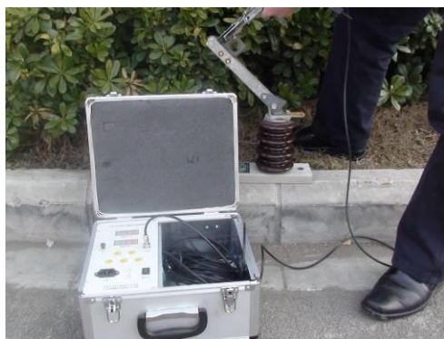
第三步 测量触指压力
