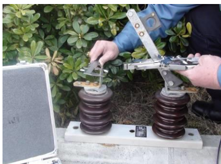
第一步 测量触头的宽度 a
