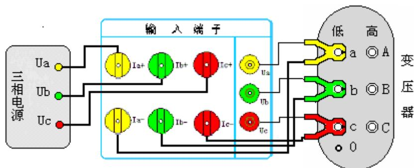
图十九 三相空载测试接线
