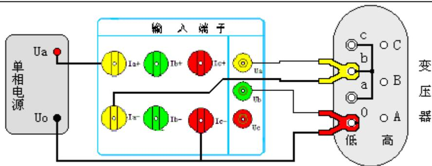
图二十二 零序阻抗测试接线
