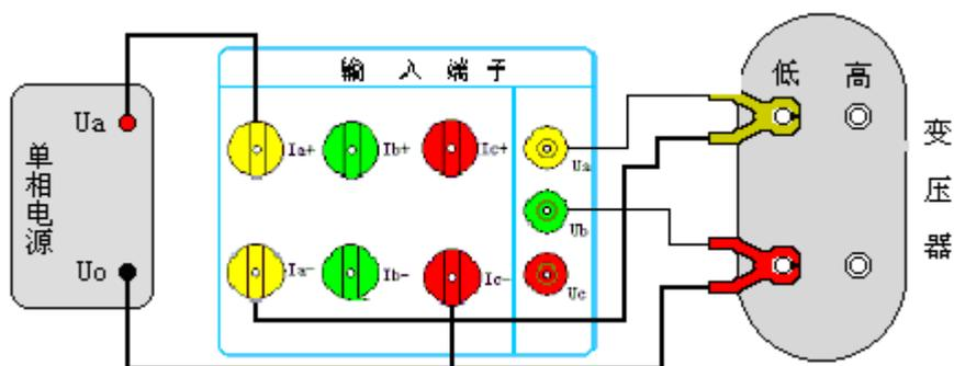
图十五 单相变压器空载试验
