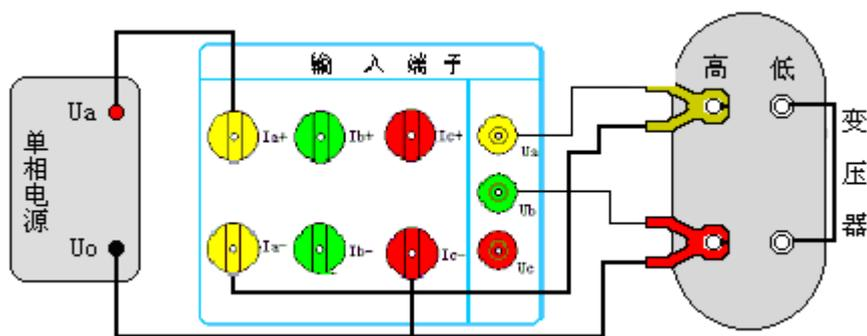
图二十 单相变压器短路试验
