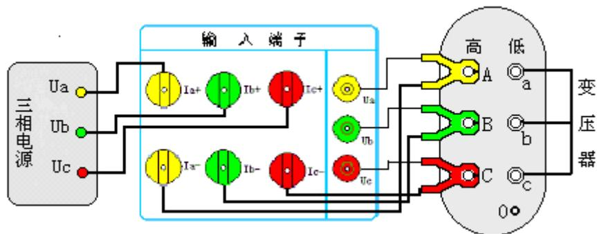
图二十一 三相短路测试接线
