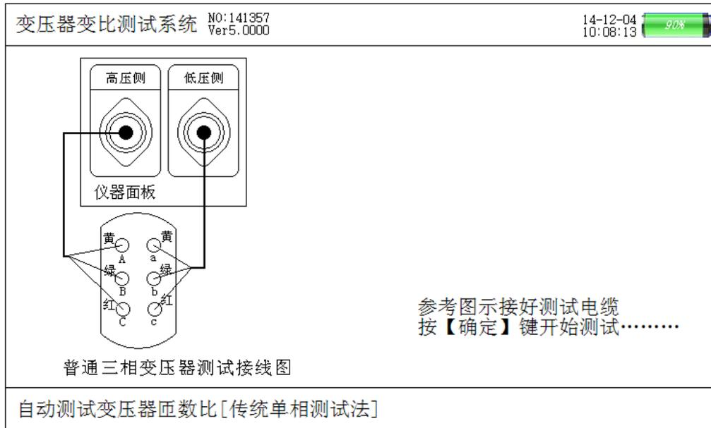
图七、三相匝数比测试接线提示屏
