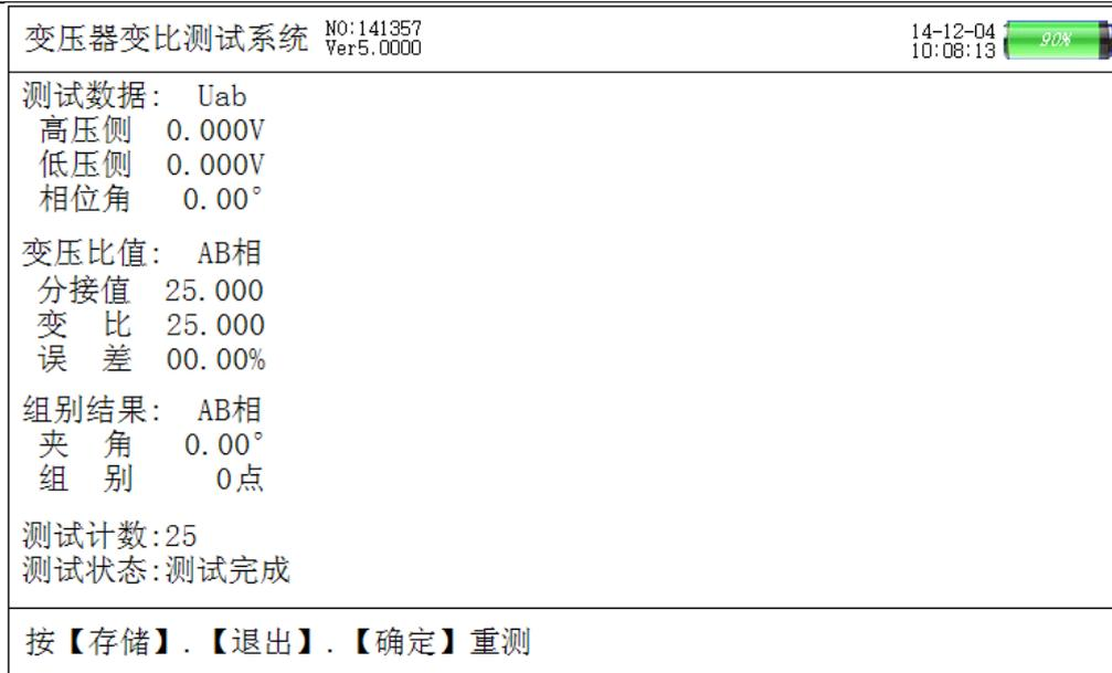
图十、单相变压器测试接线结果屏
