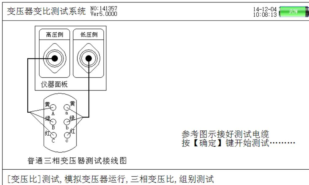
图五、三相变比测试接线提示屏
