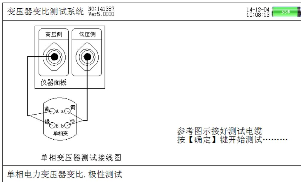
图九、单相变压器测试接线提示屏
